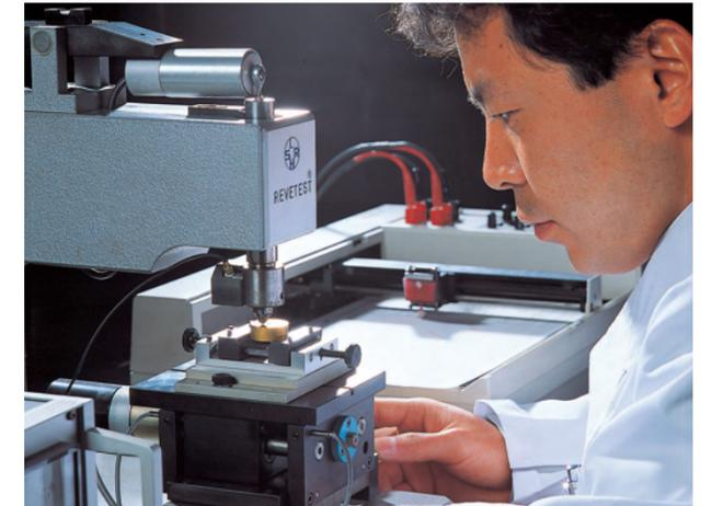
表面処理部品の密着力測定
