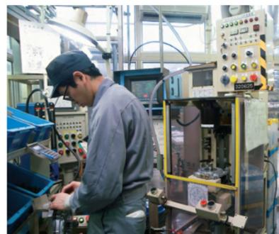
製造ラインでハウジングとローターのクリアランスが一点一点チェックされます
