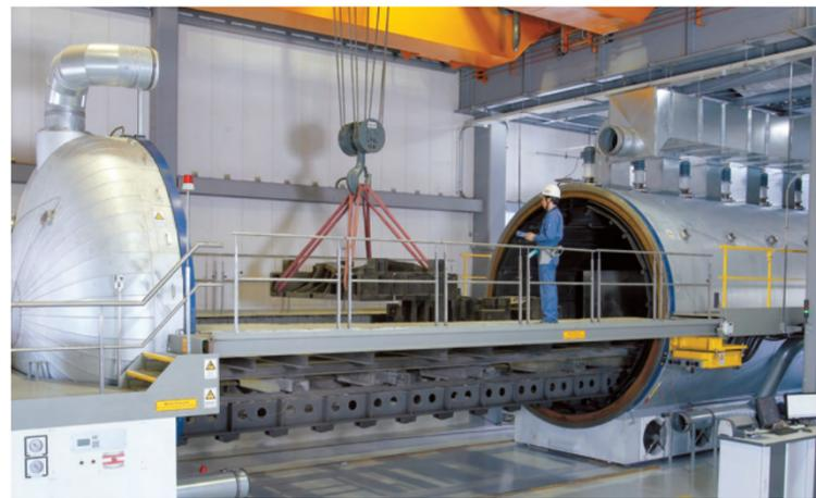
PPD炉で大型鋳物型への窒化処理を提供します
