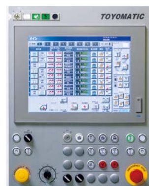
独自開発の対話型CNC装置 「TOYOMATIC」
