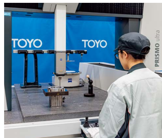
加工部品の3次元測定
