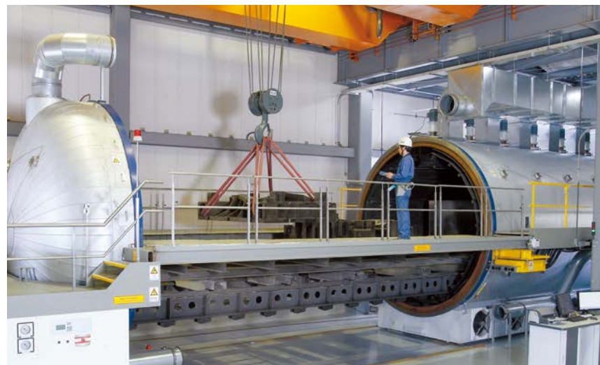
PPD炉ではメートル級の大型金型等への窒化処理を提供します
